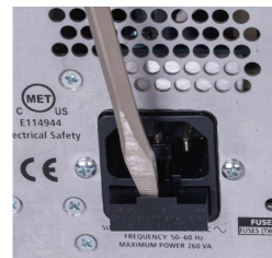
Extracción de portador de fusibles
